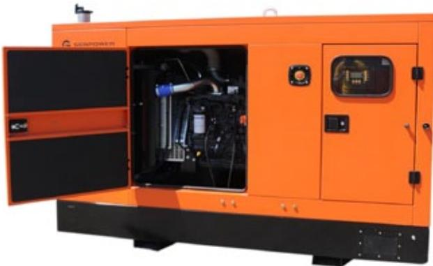
Кожух изготовлен из оцинкованных жести Zintec имеющие толщину 2-3 мм. Порошковое покрытие в произвольном цвете и структуре покрытия. Края жести загнуты внутрь кожуха. Рамы и ваки окрашены химической устойчивостью.
